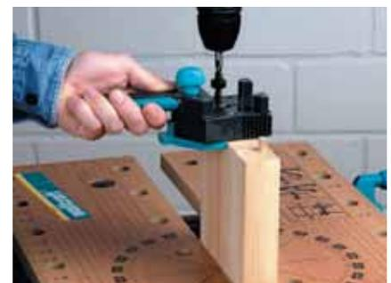
Serrez les deux planches à l'aide par exemple d'un établi de serrage. Faites glisser la rainure d'ajustement du guide de perçage à main levée sur le tourillon puis percez dans le canon correspondant. Pour finir, encollez les planches.
