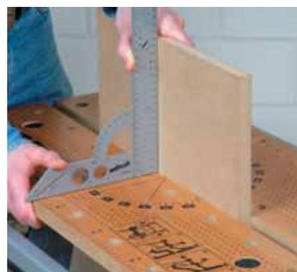
Serrez ensuite une planche à la verticale dans l'établi. Vérifiez que la planche est exactement perpendiculaire à la surface de la table à l'aide d'une équerre.
