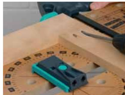
Quel que soit l'assemblage réalisé, l'important est que les pièces à usiner soient fixées de manière exacte et solide par serre-joint afin qu'elles ne puissent pas bouger lors du vissage. Plus vous travaillez avec précision et soin, plus la qualité de l'assemblage sera parfaite.
