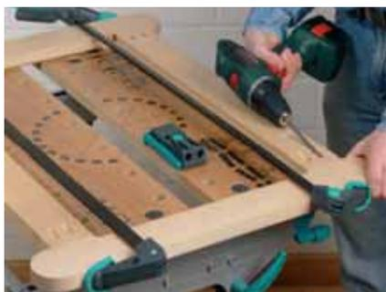
Les encadrements de tableau ou les coffrages de radiateur sont des exemples d'application idéale pour l'Undercover Jig. Après avoir percé deux trous aux extrémités de chaque pièce horizontale du cadre, il suffit de maintenir le cadre entier avec deux serre-joints et de le visser avec deux vis à bois par angle pour un assemblage durable et solide. Les perçages appliqués sur la face cachée ne seront donc pas visibles une fois le cadre ou le coffrage posé.
