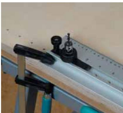
Pour percer d'autres trous en série, ôtez les serre-joints, glissez la règle dans le prolongement en utilisant comme repère le dernier perçage qui doit coïncider avec la première encoche puis serrez.
