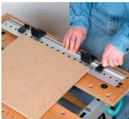
Centrez le dos de la règle sous la planche et serrez les butées latérales gauche et droite à la planche dans le trou le plus proche.
