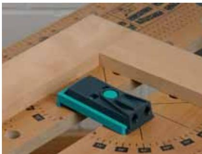
L'assemblage à vis invisible offre une alternative rapide et extrêmement solide pour les assemblages à plat. Les perçages seulement visibles de dos ne dérangent pas sur les encadrements de tableaux et les coffrages de radiateur. Ces perçages peuvent aussi être facilement bouchés de façon pratiquement invisible par un mastic de couleur appropriée ou les bouchons obliques fournis.
