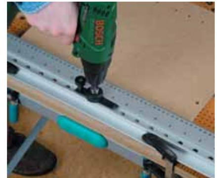
Ajustez le côté plat non gradué de la règle au chant de la planche, puis fixez avec deux serre-joints.
