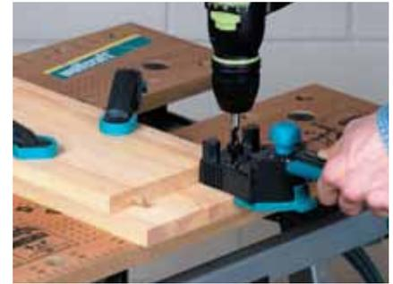
Superposez la planche avec tourillons sur la deuxième planche, engagez le guide jusqu'à la butée en insérant un tourillon dans la rainure du guide. Serrez à l'aide d'un serre-joint les deux planches décalées à souhait et percez en plaquant le guide contre sa butée.
