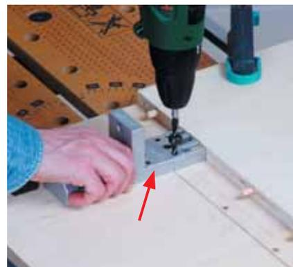
Faites glisser le guide universel sur le tourillon à l'aide de la rainure d'ajustement correspondante et percez.
