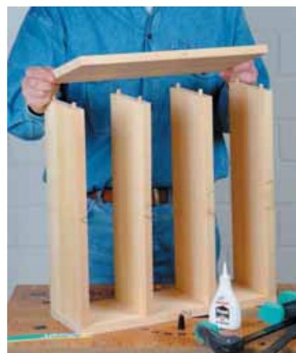
Ne pas mettre seulement de la colle dans les trous des tourillons, mais aussi sur toute la surface de contact des deux planches afin de renforcer la solidité de l'assemblage.
