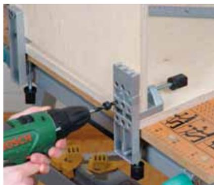
Ensuite, percez le canon du guide bas et haut correspondant au diamètre souhaité. La surface et le chant sont alors symétriquement percés en une seule opération.
