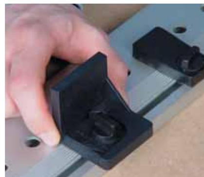
Ajustez la butée d'angle à la valeur la plus proche de l'épaisseur de bois. (ex : ajuster à 20 pour une épaisseur de bois de 19 mm)
