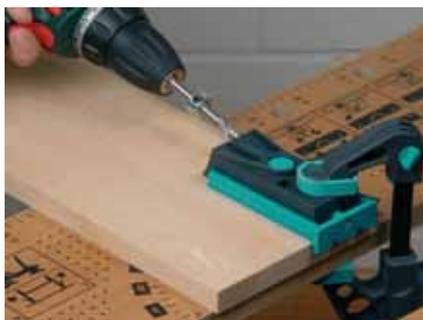
Posez l'“Undercover Jig“ sur la planche à percer en plaçant la butée contre son chant. Fixez le tout fermement sur un plan de travail à l'aide d'un serre-joint. Montez le foret sur perceuse avec la bague de butée de profondeur préalablement ajustée puis percez jusqu'à la bague de butée. Toujours avancer et reculer le foret pour mieux évacuer les copeaux.
