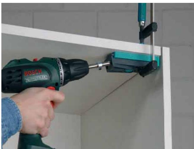
Pivotez la butée pour percer ! Lorsque la butée est pivotée, les angles d'armoire défectueux peuvent de nouveau être assemblés sans que l'armoire ne doive être démontée. Pour cela, l'“Undercover Jig“ est tout simplement fixé dans l'angle interne à réparer.
