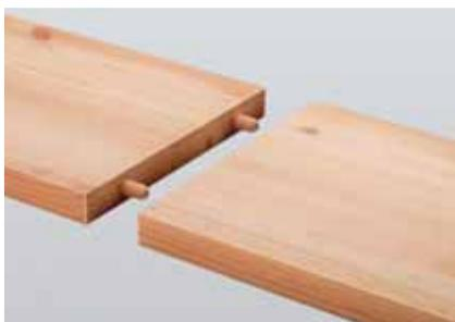
Pour les assemblages de surfaces à plat, le tourillon est enfoncé à moitié, plus env. 2 mm d'air pour la colle dans les planches.
