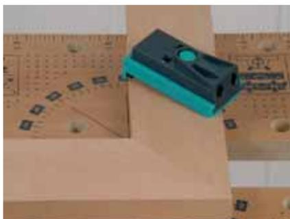
Assembler des onglets parfaitement est déjà une performance en soi. Avec l'Undercover Jig, ce travail se réussit pourtant d'emblée. Les pièces à usiner doivent seulement être fixées à l'établi par un serre-joint afin de garantir un assemblage à onglet précis sans joint apparent.
