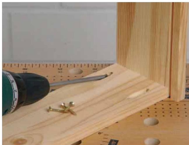
Vissez ! Retirez le guide de l'angle puis vissez avec l'embout spécial de vissage et les vis à bois. Etant donné que le perçage s'effectue avec le guide et la surépaisseur de la butée de 5 mm, les vis utilisées doivent être plus longues de 5 mm. Une autre possibilité est d'utiliser les longueurs de vis préconisées dans le tableau de la notice mais de reculer la bague de butée du foret de 5 mm.
