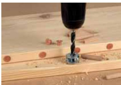
Les marqueurs pour tourillons, appelés aussi pointes à tourillons, sont une aide précieuse pour le repérage des trous opposés en parfaite symétrie. Enfoncez les marqueurs dans les trous percés de la première planche. Pressez celle-ci contre la seconde planche à percer. Les pointes marquent avec exactitude les points symétriques de perçage des trous.
