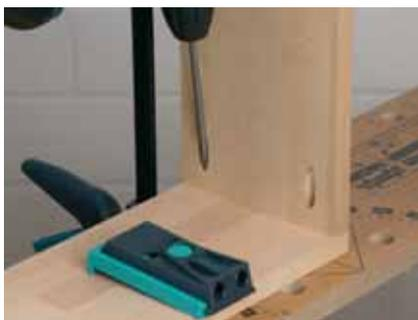
Pour finir, fixez très exactement les pièces en bois à assembler avec un serre-joint. Plus la fixation de l'assemblage est précise, plus le résultat sera parfait. Montez l'embout spécial sur la perceuse ou visseuse, sélectionnez la vis adaptée à la planche (voir tableau page 19) puis vissez. C'est prêt !
