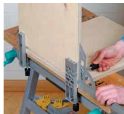
Introduisez à la verticale la planche latérale dans le guide, alignez exactement les chants des deux planches à l'aide d'une équerre, puis serrez.
