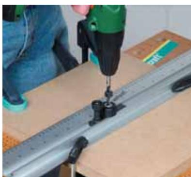
Prenez garde à ce que le chariot de perçage prenne encoche dans les mêmes trous de la règle que lors des perçages précédents.
