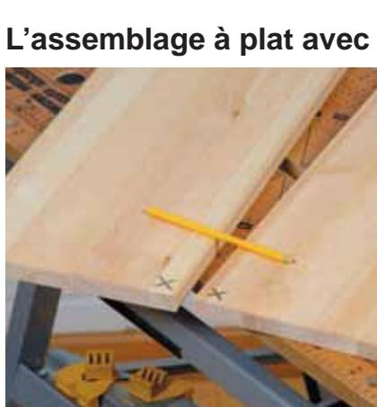
Le guide d'assemblage universel permet également d'assembler avec rapidité et précision les chants frontaux ou longitudinaux de deux planches.
