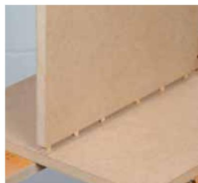
Avant l'encollage, veuillez pré-assembler les différents éléments afin de vérifier que les tourillons s'emboîtent parfaitement dans les trous.
