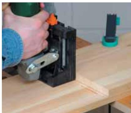
Rabattez ensuite la planche latérale sur la tablette basse, l'ajustez sur le repère et serrez. Placez la machine à la verticale, en butée contre le chant de la planche supérieure ...
