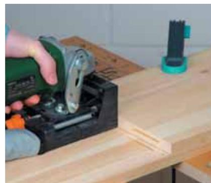
... et rainurez la tablette. Placez ensuite la machine à plat et rainurez le chant de la planche supérieure.
