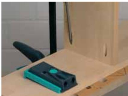
Le perçage est ici effectué de la même manière que pour l'assemblage d'angle. Pour finir, la planche percée est simplement fixée par un serre-joint sur la planche opposée dans la position souhaitée, puis vissée avec les vis adéquates. Si l'assemblage ne doit pas toujours être démonté, il peut être encollé en vue d'une plus grande solidité.
