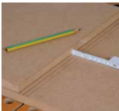
Pour tracer la ligne médiane de perçage des trous, positionnez la planche latérale sur chant, tracez les bords extérieurs puis mesurez et marquez de deux points le milieu avant de tracer.
