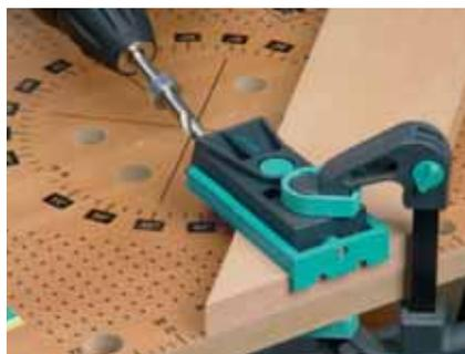
L'un des angles est serré avec le gabarit de perçage sur l'établi. Il convient toujours de percer deux trous par onglet, ceci pour des raisons de stabilité et pour que l'onglet ne se décale pas. Sur les cadres particulièrement étroits, ne percez qu'un trou et encollez la pièce pour renforcer l'assemblage.
