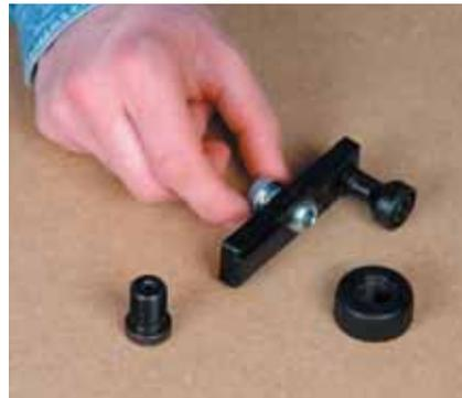
Changez le canon de perçage en place contre le canon de diamètre 5 mm adapté aux taquets usuels du commerce.
