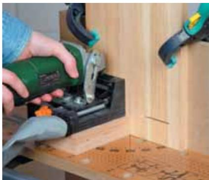
Si vous souhaitez assembler la tablette basse plus haut, par exemple pour démarrer au-dessus d'une plinthe, il suffit de surélever la machine à l'aide d'une pièce de bois à l'épaisseur souhaitée !
