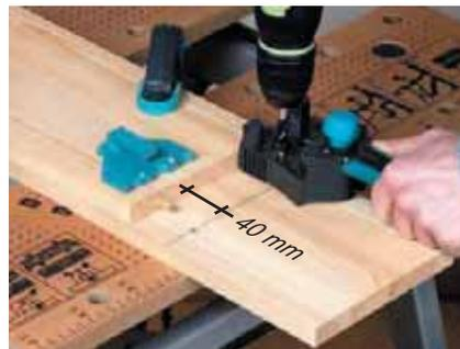
contact. Superposer la première planche déjà percée et tourillonnée en décalé à 40 mm de distance du trait puis fixez le tout à l'aide de serre-joints. Faites
