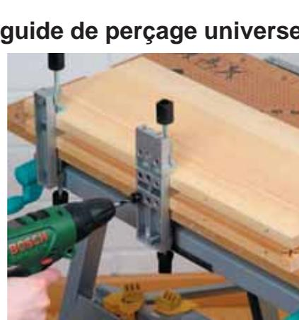
Les deux planches sont serrées simultanément dans le guide. Cela garantit le parfait ajustement des trous opposés.
