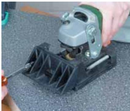
Pour assembler un plan de travail de cuisine avec des lamelles, il convient d'abord de monter la butée fournie.
