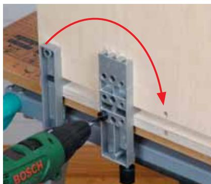
Faites glisser le guide universel de telle manière à percer le trou suivant. Pour finir, inversez le serre-planches ...
