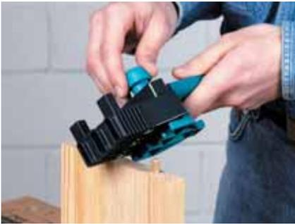
Ajustez la butée du guide de perçage sur les tourillons déjà en place; pour cela, desserrer la vis de fixation du guide et introduire le tourillon dans le canon correspondant.
