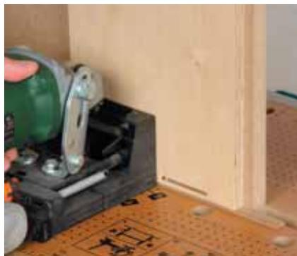
Pour effectuer le fraisage sur des planches de faible épaisseur (<20 mm), il faut surélever les planches à l'aide d'une tablette de contreplaqué de 4 mm ou plus afin d'obtenir ...
