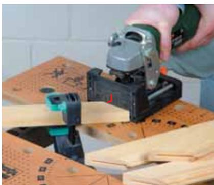
Fixez ensuite la baguette et ajustez le centre de la butée de la machine sur le repère au crayon.
