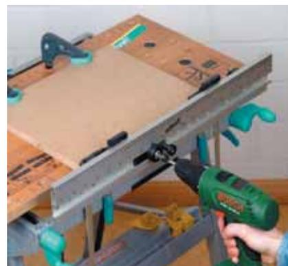
Placez la règle à l'aide de la butée d'angle gauche contre l'extrémité gauche de la planche, puis fixez le tout avec des serre-joints sur le plan de travail.
