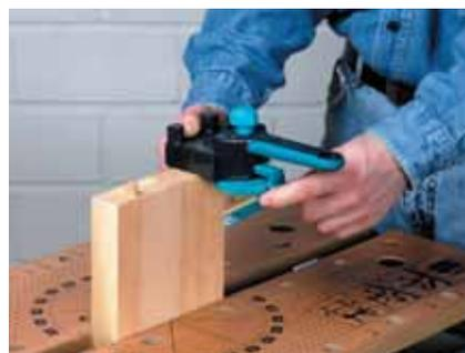
Fixez les deux planches l'une contre l'autre parfaitement alignées, plaquez le guide avec butée pré-réglée contre la deuxième planche à percer en l'engageant jusqu'au tourillon de la première planche grâce à la rainure de guidage. Percez !
