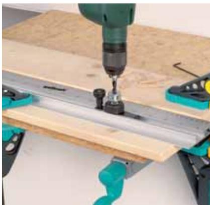
1. Introduire toujours le foret dans le canon de perçage avant de mettre la perceuse en circuit.
