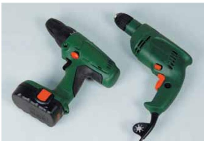
Une simple perceuse ou visseuse sans fil suffira pour réaliser les perçages pour tourillons. La visseuse sans fil présente l'avantage de ne pas gêner le travail et s'avère en général plus légère qu'une perceuse électrique. Lors du perçage avec visseuse sans fil, veillez surtout à percer en seconde vitesse (la plus rapide) et à mettre hors circuit le réglage du couple et/ou à vous positionner sur le symbole „perçage“.
