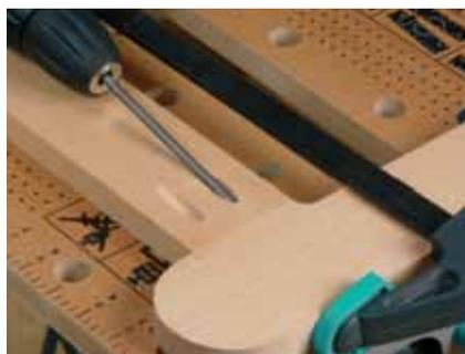
Quelle que soit la forme de l'encadrement ou de son angle, l'Undercover Jig a besoin de seulement deux vis à bois courantes (Pozidriv n°2) pour assembler pratiquement tout, de façon simple et rapide. Ces vis s'achètent en magasin de bricolage dans tout rayon de quincaillerie.
