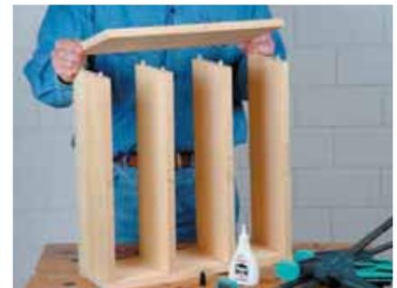
glisser la rainure d'ajustement du guide de perçage à main levée sur le tourillon puis percez dans le canon correspondant. Pour finir, encollez les planches.
