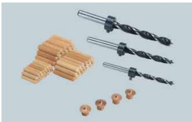
**Les accessoires d'assemblage** : les principaux accessoires sont les tourillons de diamètres standards 6, 8 et 10 mm, les forets à bois correspondants avec bague de profondeur et les marqueurs des trous opposés.
