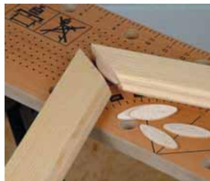
Adaptez la dimension de la lamelle à l'onglet. Il est préférable d'assembler les baguettes particulièrement étroites avec des tourillons.
