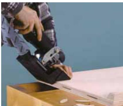
Pour des onglets exacts à 45 degrés, utilisez la butée en la montant simplement sur son autre face.
