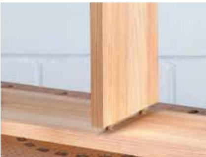
Le guide de perçage à main levée est utilisé sans butée d'angle pour ce type d'assemblage. Tracez le trait de positionnement du T sur la deuxième planche de
