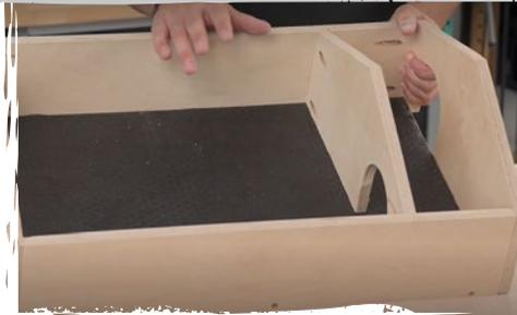
Verschraubt nun die **Bodenplatte** unter dem zuvor montierten Korpus.
