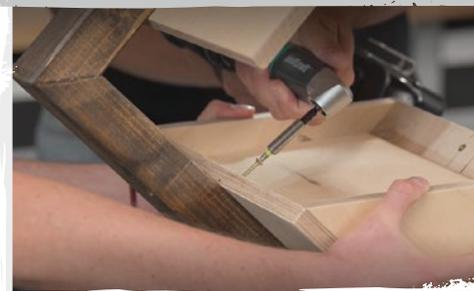
Setzt die **Futterkrippe** nun gegenüber vom Dach in den Rahmen und befestigt diese wie im Schritt zuvor mit einer sichtbaren Verschraubung. Achtet auch hier auf die gleichen Überstände nach links und rechts.
