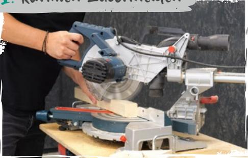
Beginnt mit dem **Zuschnitt** des Rahmens auf dem **MASTER work 1600** mit der Kapp- und Gehrungssäge. Schneidet die vier **Kanthölzer** an beiden Enden auf **45° Gehrung**, sodass die längste Seite des Holzes 42 cm lang ist.
