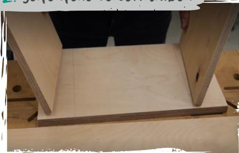
Verschraubt die beiden **Seitenteile** von unten mit der **Bodenplatte** und achtet dabei auf einen identischen Abstand nach links und rechts.
