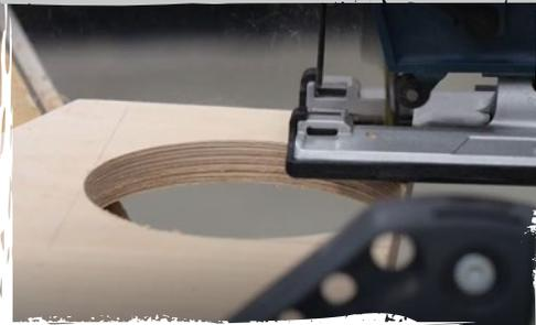
Mit der **Lochsäge** stellt ihr nun zwei Löcher für den **Eingang** und den **Durchgang** in der Trennwand her. Sägt anschließend mit der **Stichsäge** die Holzüberstände am unteren Rand der Platte ab, sodass eine **Rundbogentür** entsteht.
