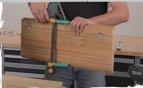
**Verleimt** die beiden übrigen **Stülp-schalungsbretter** im Überdeckungsbereich (Nut und Feder) miteinander und fixiert sie temporär mit einer **Einhand-zwinde**, bis der Leim getrocknet ist.
