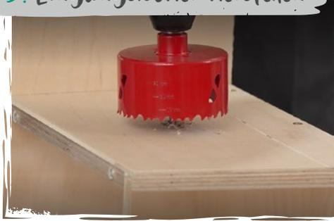
Zeichnet die Positionen für die beiden **Eingangslöcher** an den Seitenteilen mittig an und sägt die Löcher mit einer **Bi-Metall Lochsäge** aus. Anschließend solltet ihr die **Schnittkanten abschleifen**.
