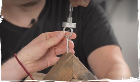
Mithilfe der mobilen Bohrhilfe **accumobil** und eines 4-mm-Bohrers bohrt ihr ein Loch auf der Dachspitze vor. Dreht dann mit dem **Hakensraubendreher** eine Hakenschraube ein, an der ihr später ein Seil befestigen könnt.
