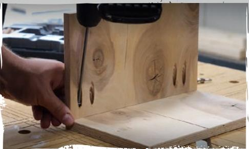
Schneidet nun die beiden Bretter für das **Dach** zurecht. Die Maße findet ihr in der Materialliste. Mithilfe des **Undercover Jigs** stellt ihr eine **unsichtbare Verschraubung** zwischen den beiden Hälften auf der Innenseite des Daches her und bildet so ein Satteldach.
