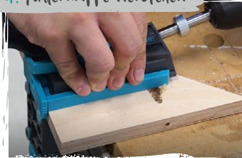
Nun folgt der **Zuschnitt** der Einzelteile für die **Futterkrippe** gemäß Materialliste. Die Bretter verschraubt ihr ebenfalls mit dem **Undercover Jig**. Setzt zuletzt die **Holzplatte** ein und verleimt sie.
