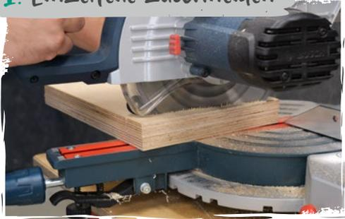
Beginnt mit dem **Zuschchnitt** der Einzelteile auf dem **MASTER work 1600** mit der Kapp- und Gehrungssäge. Die Maße entnehmt ihr der Materialliste.
