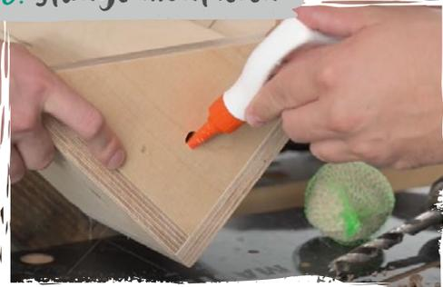
Bringt zuletzt noch den **Futterhalter** bzw. die Sitzstange an. Zeichnet dafür die Bohrposition mittig zu den Seiten des Futtertrogs an, bohrt mit einem 8-mm-Bohrer vor, setzt einen 8 mm dicken **Dübel** ein und verleimt diesen.
