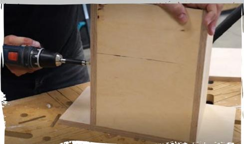
Setzt nun die **Rückwand** zwischen die Seitenteile und verschraubt sie links und rechts.
