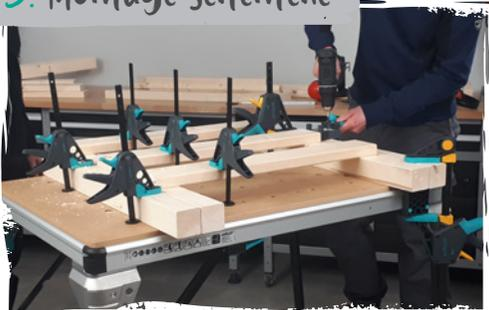
Nun werden die Seitenteile und die Schiebetür mittels **Dübelverbindungen** montiert. Für die **Eckverbindungen** nimmst du zunächst alle Stirnbohrungen vor. Anschließend richtest du alle Elemente so zueinander aus, wie sie miteinander verbunden werden sollen. Jetzt wird **gebohrt**. Abschließend werden sowohl die **Dübel** als auch die **Verbindungsflächen verleimt**.
