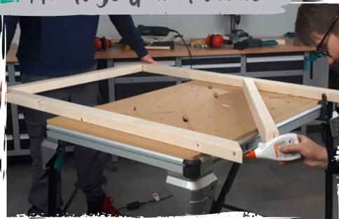
Im nächsten Schritt baust du nun deinen Grundrahmen zusammen. Die vier Holzbalken verbindest du mit **Flachdübeln**, hierbei hilft dir unsere **Multi-Holzfräse**. Achte nach der Fräsung darauf, dass du beim **Verleimen** neben den Dübeln auch die Verbindungsflächen berücksichtigst.
