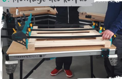
Über die vorgefertigten **Dübellöcher** wird der Korpus nun **zusammengebaut**. Mit den Dübeln **verleimen, spannen** und am besten über Nacht **trocken lassen**.
