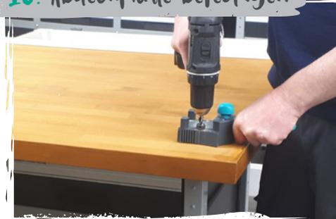
Jetzt kannst du die Abdeckplatte auf dem Korpus befestigen. Auch hierbei nutzen wir **Dübelverbindungen**. Durch den Einsatz eines **Tiefenstopps** sichern wir uns gegen ein mögliches Durchbohren durch die Platte ab. Anschließend wird wie gehabt alles durch **Dübel und Leim verbunden**.
