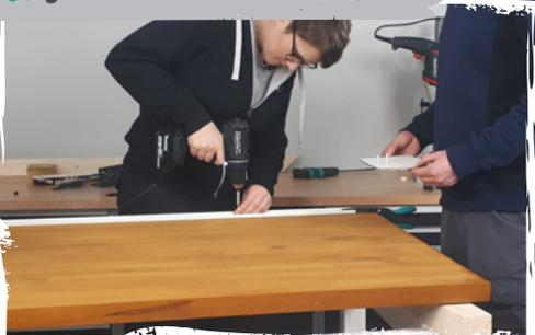
Montiere nun die vorbereiteten Schienen. Sie werden am Grundgestell jeweils **unten und oben verschraubt**. Das Element der **Schiebetür** kann dann später ganz einfach eingeführt werden.
