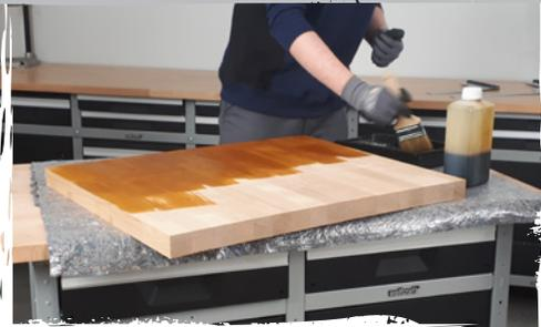
Nun wird die Abdeckplatte in einem Eicheton **gebeizt**. Zuvor muss die Platte allerdings bearbeitet werden (**Wässern, Schleifen**). Die Beize sollte zwei bis drei Stunden trocknen. Weiter geht es mit dem Versiegeln durch einen **Klarlack** auf Acrylbasis. Nach Einhaltung der **Trocknungszeit** solltest du nochmals anschleifen und lackieren.
