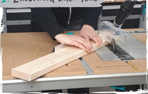
Du beginnst mit dem Zuschnitt der Einzelteile auf dem MASTER cut 2600. Die Maße entnimmst du der **technischen Zeichnung**.
