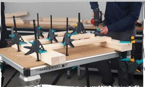
Ora possiamo procedere a montare le parti laterali e la porta scorrevole mediante **giunzioni a spine**. Per realizzare le **giunzioni ad angolo**, eseguiamo dapprima tutti i fori frontali. Dobbiamo quindi posizionare tutti gli elementi nella direzione in cui devono essere uniti. Iniziamo a **forare**. Procediamo a **incollare** non solo le spine ma anche le **superfici di collegamento**.
