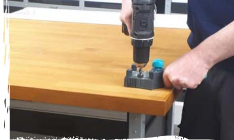
Ora è possibile fissare il pannello di copertura al corpo. Anche in questo caso utilizziamo delle giunzioni a spine. L'impiego di un arresto di profondità ci consente di evitare di perforare interamente il pannello. Poi, come di consueto, tutto viene collegato con colla e spine.
