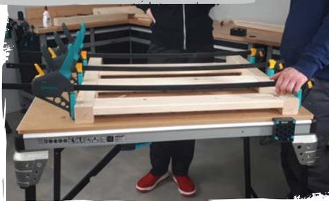
Ora possiamo assemblare il corpo utilizzando i **fori** precedentemente realizzati. **Incollare** con le spine, serrare e lasciare asciugare preferibilmente tutta la notte.
