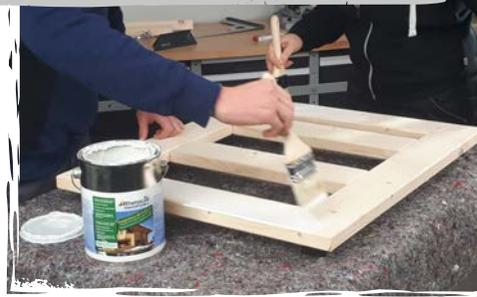
Dopo avere rispettato i **tempi di asciugatura** possiamo procedere alla levigatura e alla verniciatura. Tutti gli elementi devono essere dapprima **levigati grossolanamente**, quindi sottoposti a **levigatura fine**. Verniciamo infine tutti gli elementi con una **vernice trasparente innocua** per i cani.
