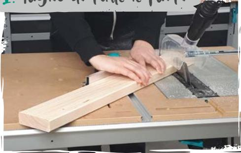
Iniziamo tagliando i singoli pezzi con la MASTER cut 2600. Le dimensioni sono reperibili nel **disegno tecnico**.
