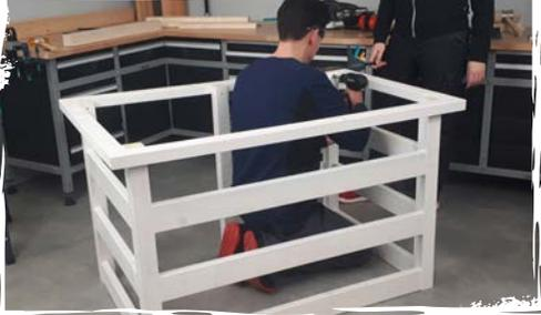
Il corpo viene ora inserito nel telaio di base. Avvitare questi due elementi. Per rendere invisibili i collegamenti a vite, realizzarli con una punta Forstner. Il foro risultante deve essere coperto con una piastrina in legno.
