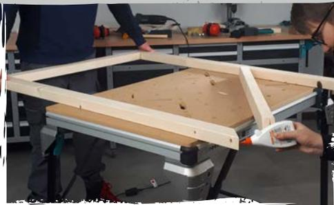
Successivamente costruiamo il telaio di base. Le quattro travi di legno vengono unite mediante **lamelli**. A tal fine consigliamo di utilizzare la nostra **fresatrice multiuso**. Dopo la fresatura ricordarsi di **incollare** non solo le spine ma anche le superfici di collegamento.
