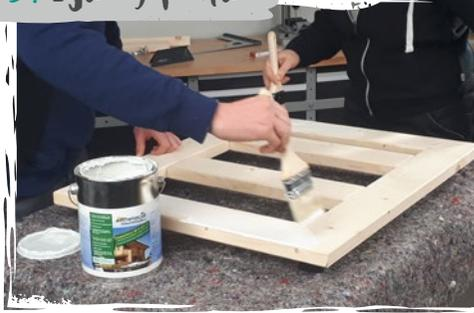
Una vez transcurridos los **tiempos de secado** continuamos con el lijado y la pintura. Todas las superficies se lijan primero con **papel de lija basto** y se continúa después con el **lijado fino**. Por último, pintamos todos los elementos con un **barniz inofensivo para perros**.
