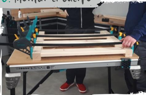
Ahora se ensambla el cuerpo utilizando los **orificios para espigas** ya realizados. Se **encola** con las espigas, se **sujeta**, y, en el mejor de los casos, se **deja secar** toda una noche.
