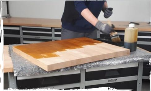
Ahora se tiñe la placa superior con un tono de roble. No obstante, antes se debe preparar el panel (**mojar, lijar**). El tinte debe secar entre dos y tres horas. Después, para cerrar los poros utilizamos un **barniz transparente con base acrílica**. Tras el **tiempo de secado** se vuelve a lijar y pintar.
