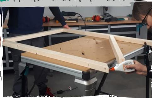
En el siguiente paso ensamblaremos el bastidor base. Unimos las cuatro vigas de madera con los **tacos de galleta**. Puedes ayudarte con nuestra **fresadora**. Tras el fresado, asegúrate de tener también en cuenta las superficies de unión además de los tacos durante el **encolado**.
